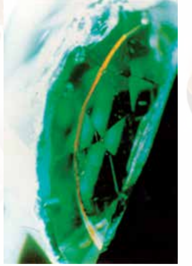
BİR KOMPOZİT TAŞTA, BÜYÜTME İLE GÖZLEMLENEBİLEN YAPIŞMA ÇİZGİSİ
